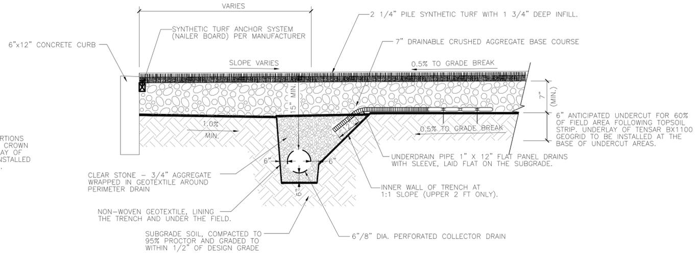
2 SYNTHETIC TURF COLLECTOR DRAIN DETAIL
